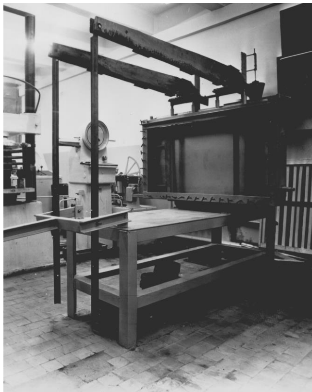
Рис. 14.1. Общий вид плоского стенда для моделирования на эквивалентных материалах (ГВУЗ «НГУ»)
